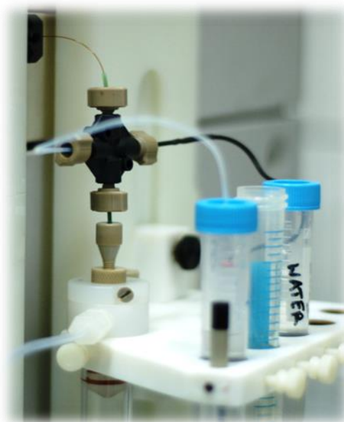
Rys. 1. Budowa połączenia krzyżowego technik CE z ICP-MS
