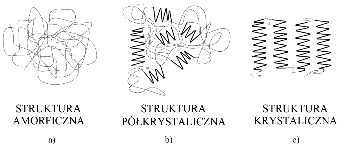
Rys. 3-3 Schemat budowy polimerów: a) struktura amorficzna, b) półkrystaliczna c) krystaliczna. Linie faliste symbolizują nieuporządkowane segmenty łańcuchów polimerowych, natomiast fragmenty uporządkowane (zaznaczone pogrubieniem) odpowiadają obszarom krystalicznym (Piergiovanni i Limbo, 2016)
