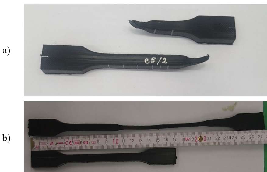
Rys. 5-3 Próbki po zakończeniu testu rozciągania: a) próbka zerwana, b) próbka wydłużona do wyczerpania zakresu maszyny wytrzymałościowej
