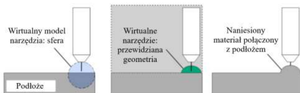
Rys. 7.2 Metoda wyznaczania geometrii napoiny na podstawie geometrii narzędzia [197]
