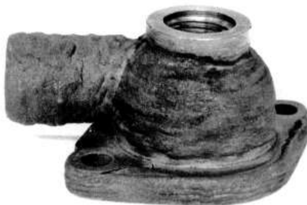
Rys. 2.2 Obudowa termostatu do samochodu marki Ford wykonana metodą WAAM [1]
