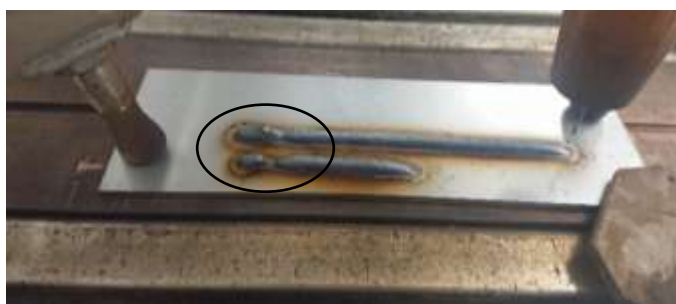
Rys. 9.10 Brak ciągłości spowodowany niestabilnością łuku
