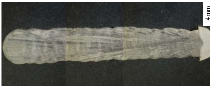
Rys. 6.1 Struktura napoiny WAAM powstała z materiału elektrody ER316LSi [Badania własne]
