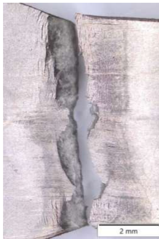
Rys. 10.50 Przebiegi przełomów po próbie statycznego rozciągania próbek: a) 65A H1; b) 65A V2; c) 90A H1; d) 90A V1
