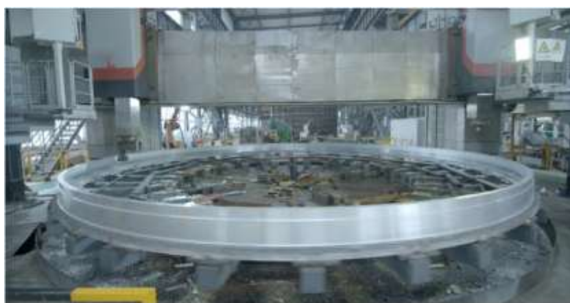
Rys. 1.4 Konektor rakiety nośnej ze stopu aluminium o średnicy 10 m wykonany metodą WAAM [9]
