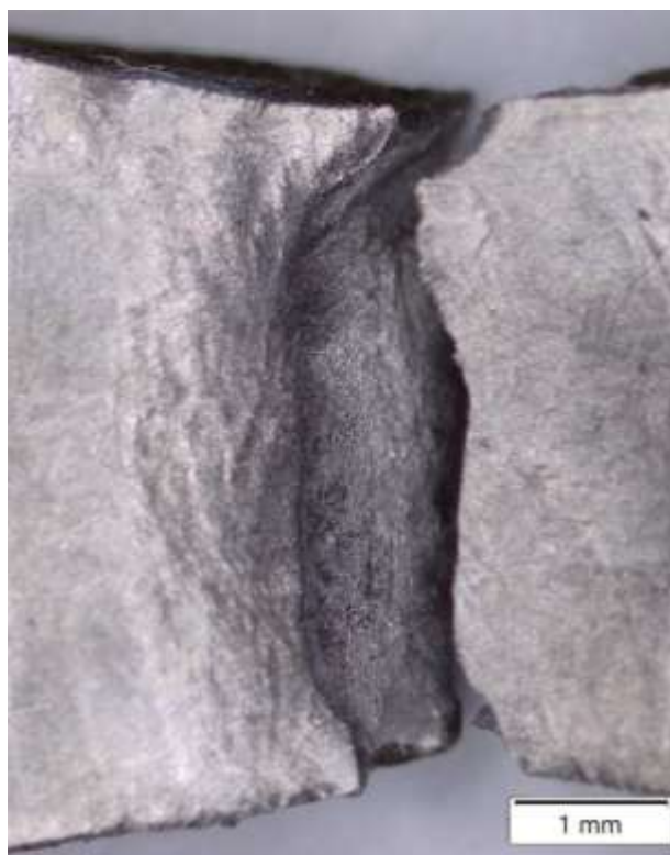
Rys. 10.50 Przebiegi przełomów po próbie statycznego rozciągania próbek: a) 65A H1; b) 65A V2; c) 90A H1; d) 90A V1
