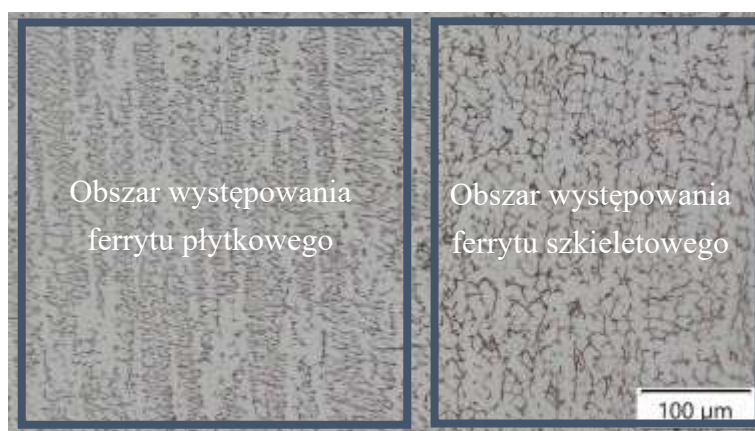
Rys. 10.40 Mikrostruktura warstwy 4 próbki 13
