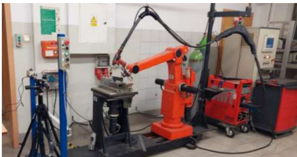
Rys. 9.2 Stanowisko do realizacji procesu WAAM składające się z Robota IRp-6 oraz źródła CMT – TPS 2700
