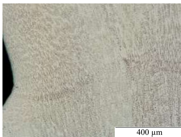
Rys. 10.13 Mikrostruktura strefy wtopienia (ponownego przetopienia) w pobliżu krawędzi napoiwy: a) Próbka WWE16, pomiędzy 15 a 16 warstwą; b) Próbka WWE24, pomiędzy 4 a 5 warstwą
