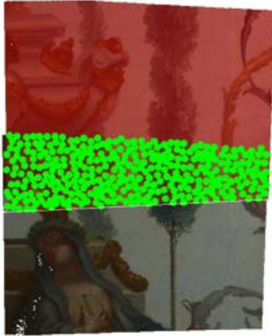
Rysunek 39: Punkty kontrolne zaznaczone na części wspólnej obu chmur punktów (korespondencje).
