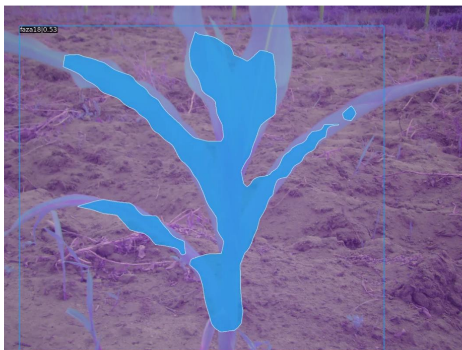
Rysunek 5.6. Wynik działania modelu HTC_r50 wytrenowanego na obrazach wielospektralnych z kamery MapIR Survey3 Red+Green+NIR.
