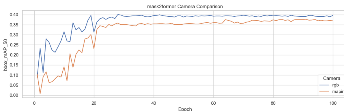
Rysunek 5.12. Przebieg uczenia modelu opartego o algorytm Mask2Former dla zobrazowania RGB oraz dla zobrazowania wielospektralnego z kamery MapIR Survey3 Red+Green+NIR.
