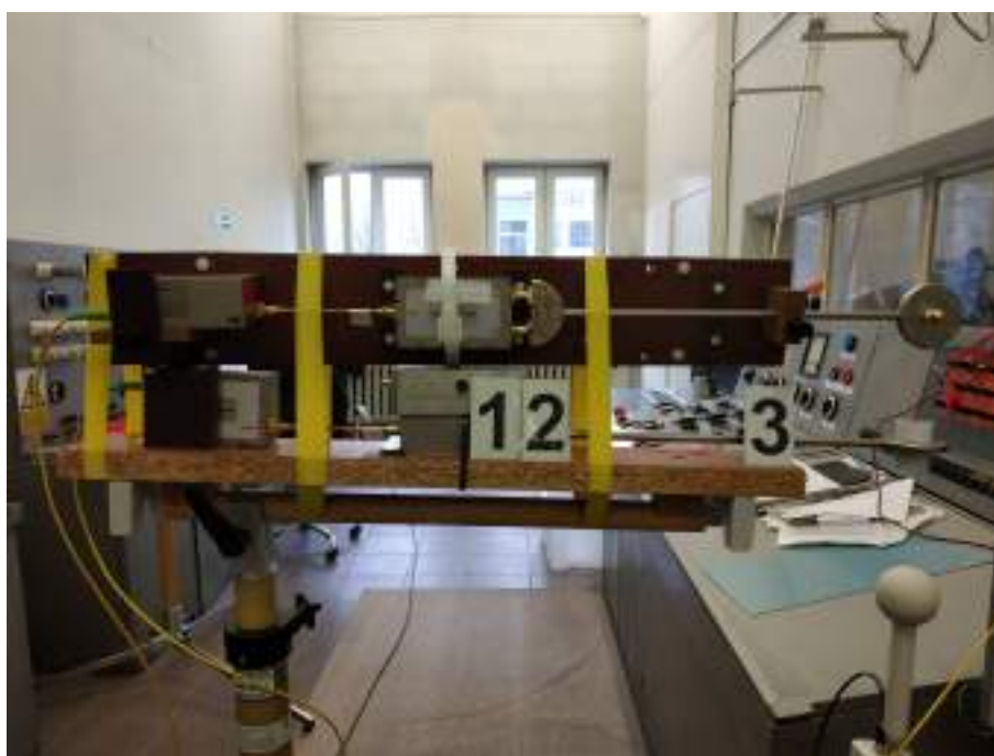
Rysunek 3.15. Pomiar pola w ustawieniu sond probierczych wzdłuż ściany działowej między laboratorium a pokojem kontrolnym.
