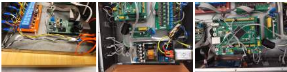
(a) Splotka przewodu zasilającego i ułożenie (b) Ferryty CM na przewodzie zasilającym i (c) Ferryt CM na przewodzie do przycisku na płycie czołowej.
