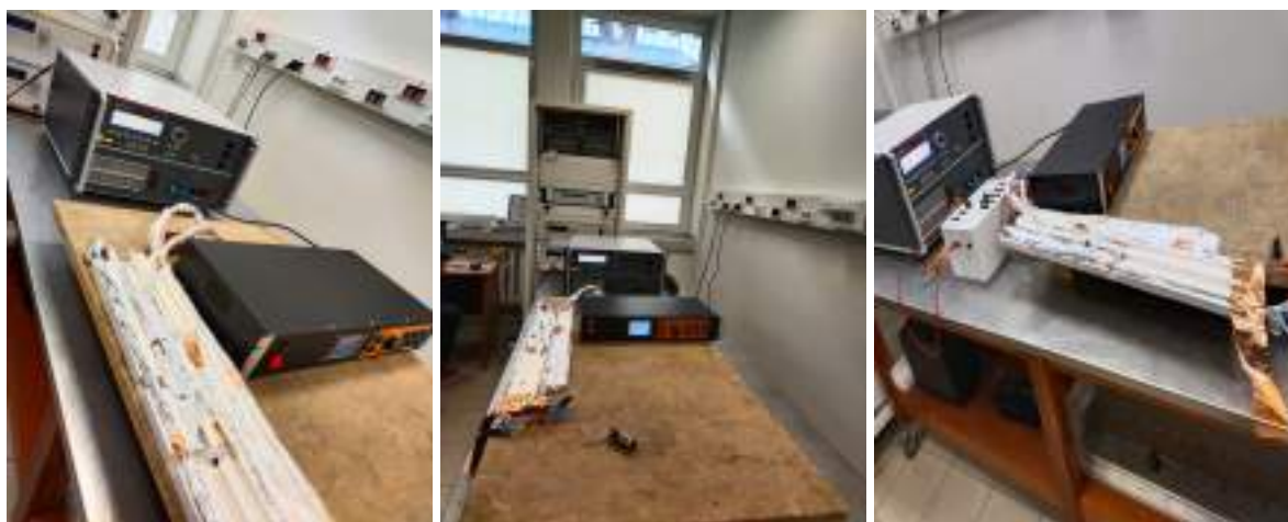
Rysunek 9.17. Nastawnik w trakcie badania odporności na DOW zgodnie z normą [32].
