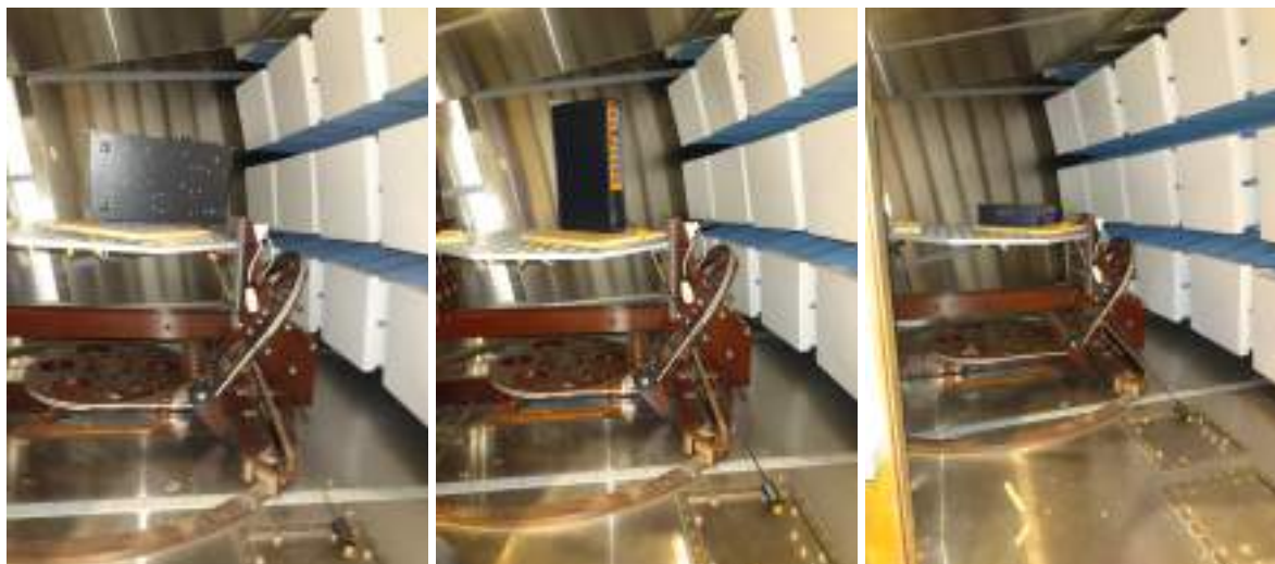
Rysunek 9.6. Ustawienie nastawnika w trzech osiach ortogonalnych w komorze GTEM, w trakcie pomiaru emisji promieniowanej.
