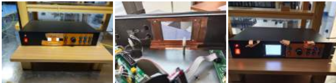
(a) Zasłonięcie otworu wyświetlacza samo- (b) Zamontowanie od wewnątrz obudowy (c) Prowizoryczne zwiększenie liczby miejsc przylepną taśmą miedzianą z przewodzącym siatki metalowej, połączonej galwanicznie z kontaktu pokrywy z podstawą obudowy za klejem.
