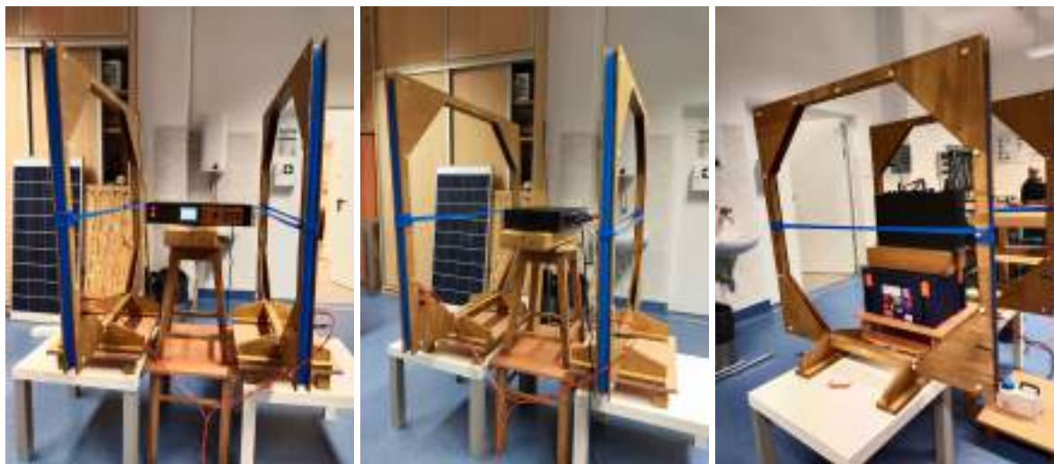
Rysunek 9.13. Ustawienie nastawnika w trzech osiach ortogonalnych w układzie cewek Helmholtza, w trakcie badania odporności na pole magnetyczne częstotliwości sieciowej zgodnie z normą [38].
