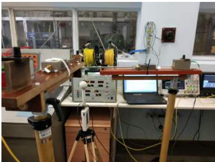
Rysunek 3.11. Pomiar pola dla pionowej orientacji sond probierczych względem ściany działowej między laboratorium a pokojem kontrolnym
