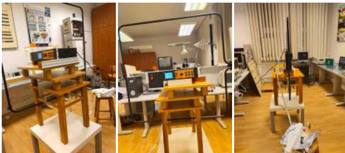
Rysunek 9.14. Ustawienie nastawnika w trzech osiach ortogonalnych w antenie pętlowej, w trakcie badania odporności na impuls pola magnetycznego zgodnie z normą [30].
