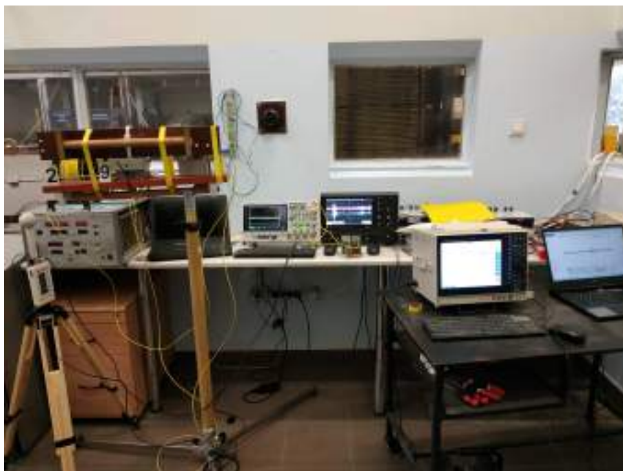
Rysunek 3.14. Układ prostopadły sond probierczych względem ściany działowej między laboratorium a pokojem kontrolnym.
