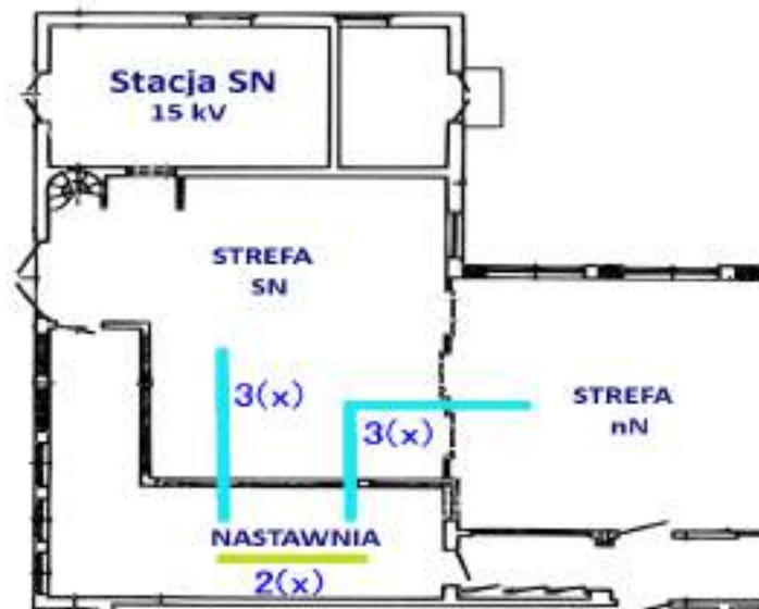
Rysunek 2.11. Rozkład stref w stacji w izolacji gazowej
