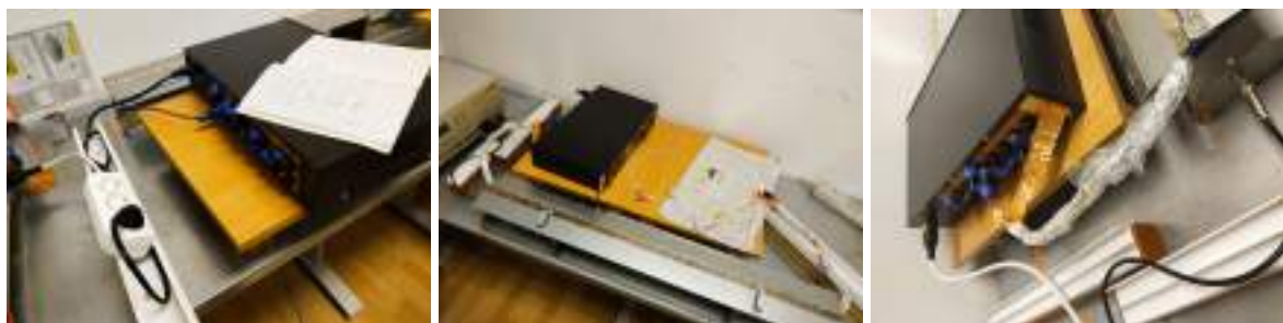
(a) Sprzężenie wewnętrzną siecią sprzęgająco-odsprzęgającą (CDN) z przewodami zasilającymi. (b) Sprzężenie cęgami pojemnościowymi (CCC) z ekranowanym przewodem sygnałowym. (c) Sprzężenie cęgami pojemnościowymi (CCC) z ekranowanym przewodem sygnałowym.
