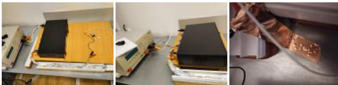
(a) Sprzężenie wewnętrznym CDN z przewodami zasilającymi. (b) Sprzężenie bezpośrednio z ekranem przewodu sygnałowego. (c) Połączenie ekranu przewodu sygnałowego do masy odniesienia na przeciwległym końcu.
