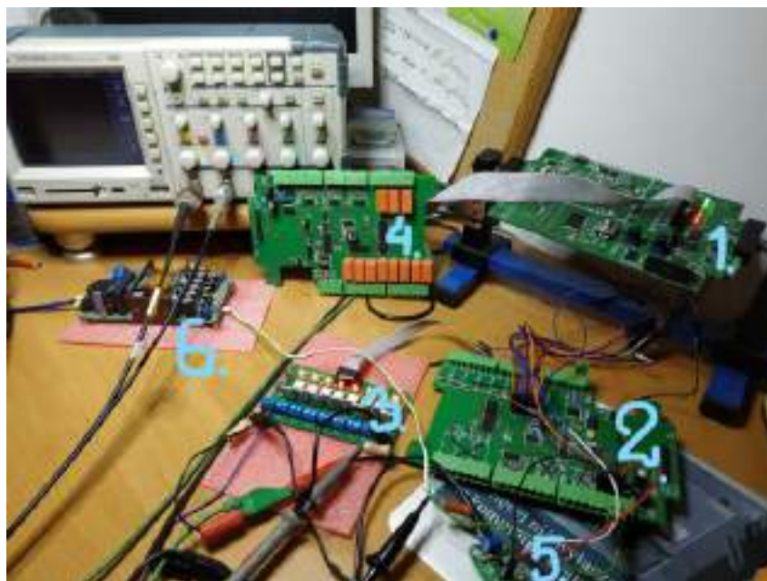
Rysunek 8.2. Prototyp II nastawnika powstały z wykorzystaniem mikrokontrolera STM32F4.
