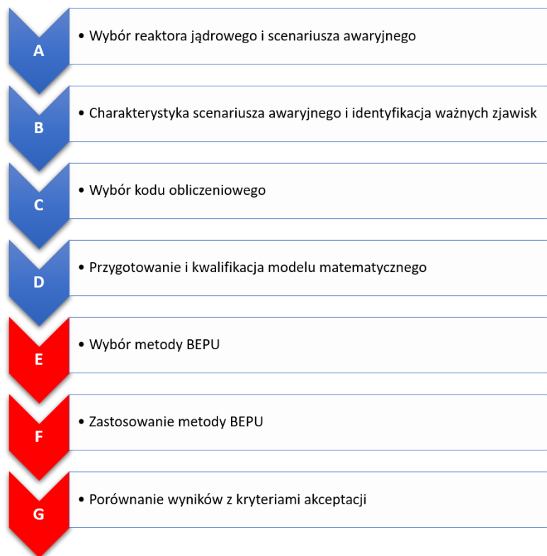
Rys. 4.1. Siedem podstawowych kroków wykonywania analiz BEPU.
