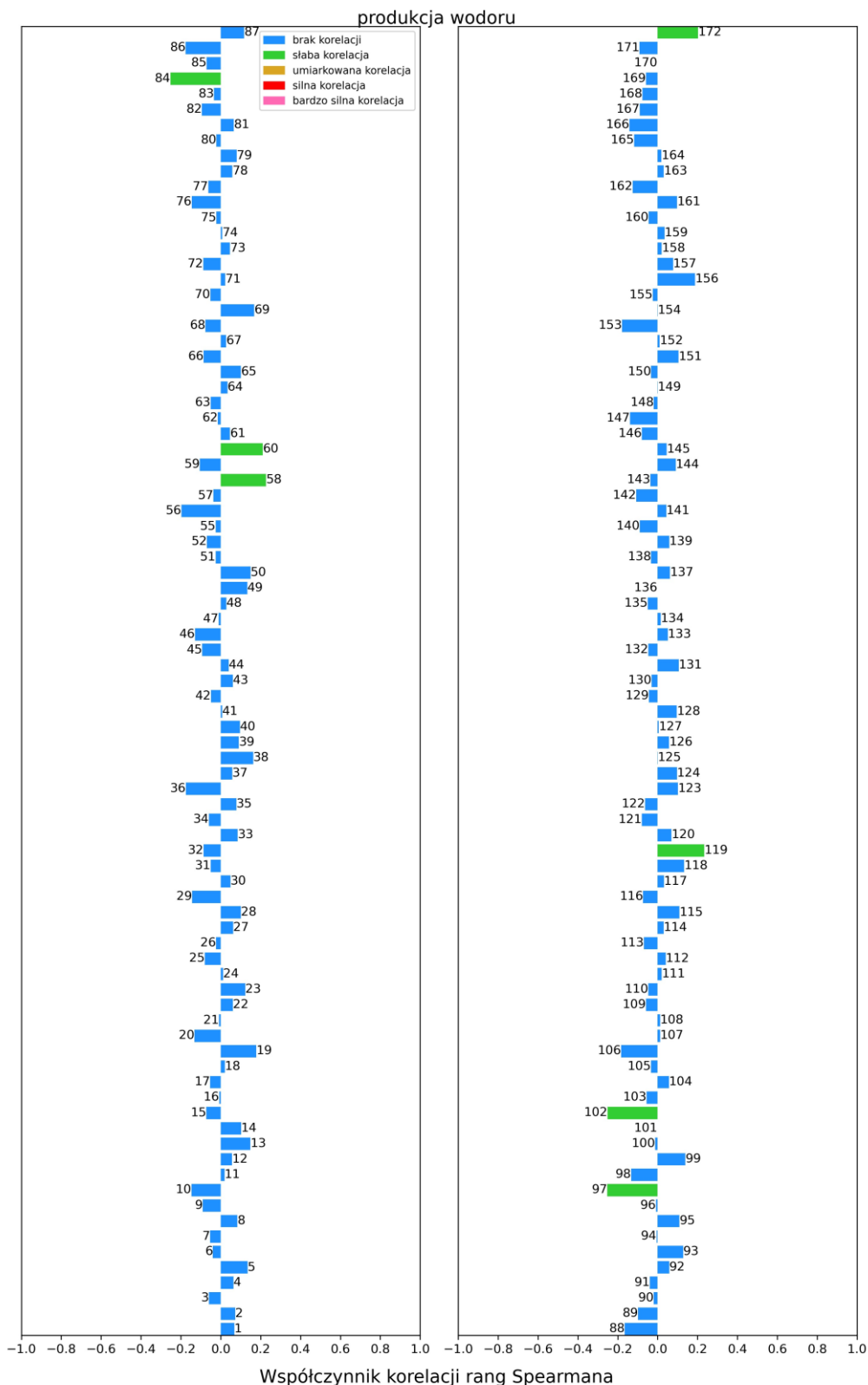
Rys. 6.2. Wartość współczynników korelacji rang Spearmana między poszczególnymi parametrami wejściowymi a maksymalną wartością produkcji wodoru w rdzeniu reaktora.
